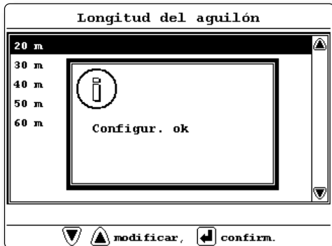
Figura: el GS820 visualiza "configuración ok"
